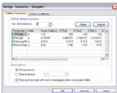
Ilustración 4: Configuración para un estudio de sensibilidad de varios parámetros utilizando escenarios de diseño
